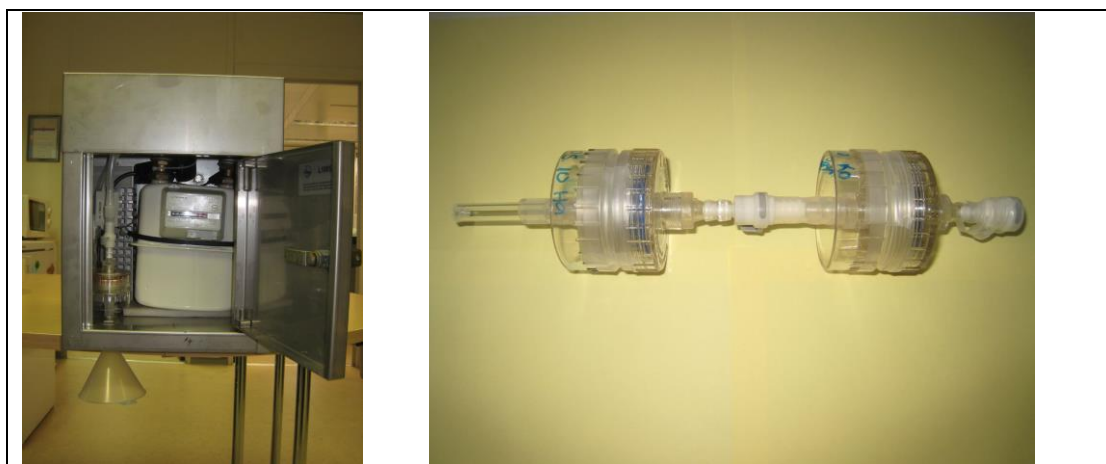
Abbildung 41 links: Offener Sufix, rechts: Summenfilter und Kontrollsummenfilter in Serie Probeneinlass, Summenfilter, ev. Kontrollsummenfilter, Gasuhr, Rotameter und Pumpe
